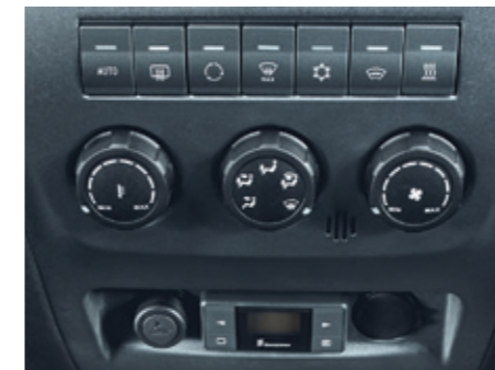
Блок управления системой кондиционирования и отопления
