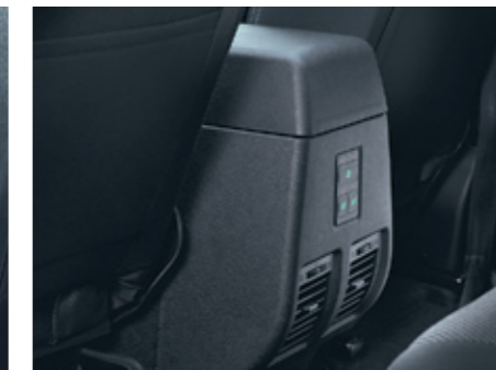
Пульт управления дополнительным отопителем и обогревом сидений для сидящих сзади пассажиров
